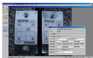
クラック進展後の計測例
