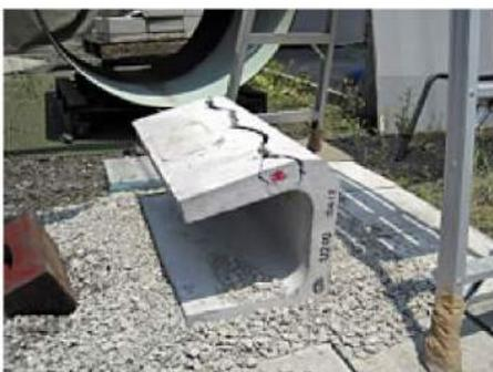
2回目（落下高さ1m）：大きく傾斜
