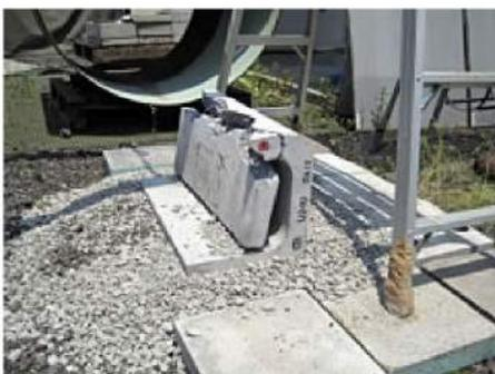
3回目（落下高さ1m）：完全に破壊
