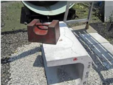
1回目（落下高さ1m）：ひび割れが発生
