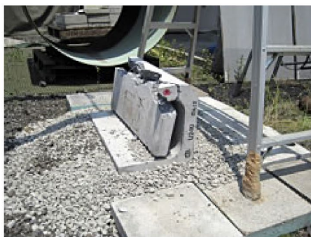
3回目（落下高さ1m）：完全に破壊
