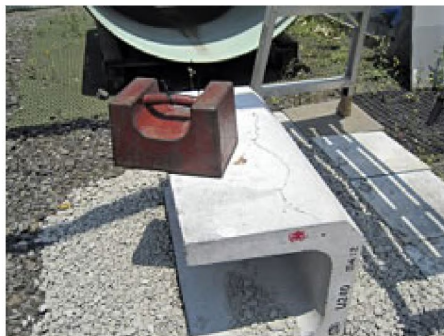
1回目（落下高さ1m）：ひび割れが発生
