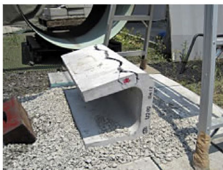
2回目（落下高さ1m）：大きく傾斜
