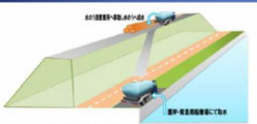
図-3 給水車を用いた水のうへの給水方法
