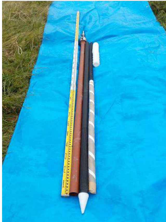
打ち込み式ウェル ( \phi 50\text{mm} 、 L=2\text{m} )
