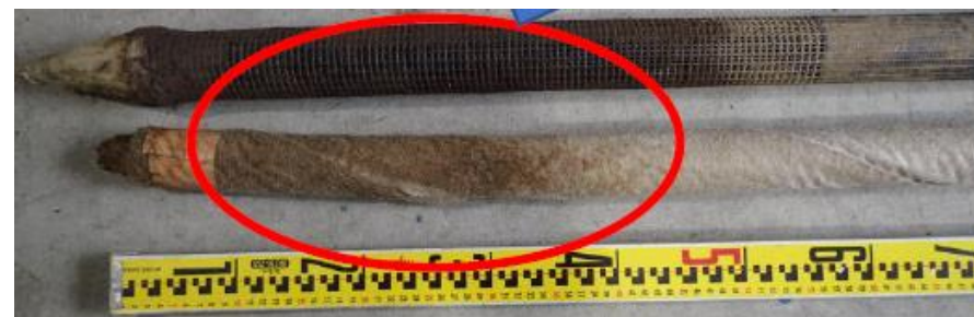
撤去後のストレーナー、フィルターの状況
