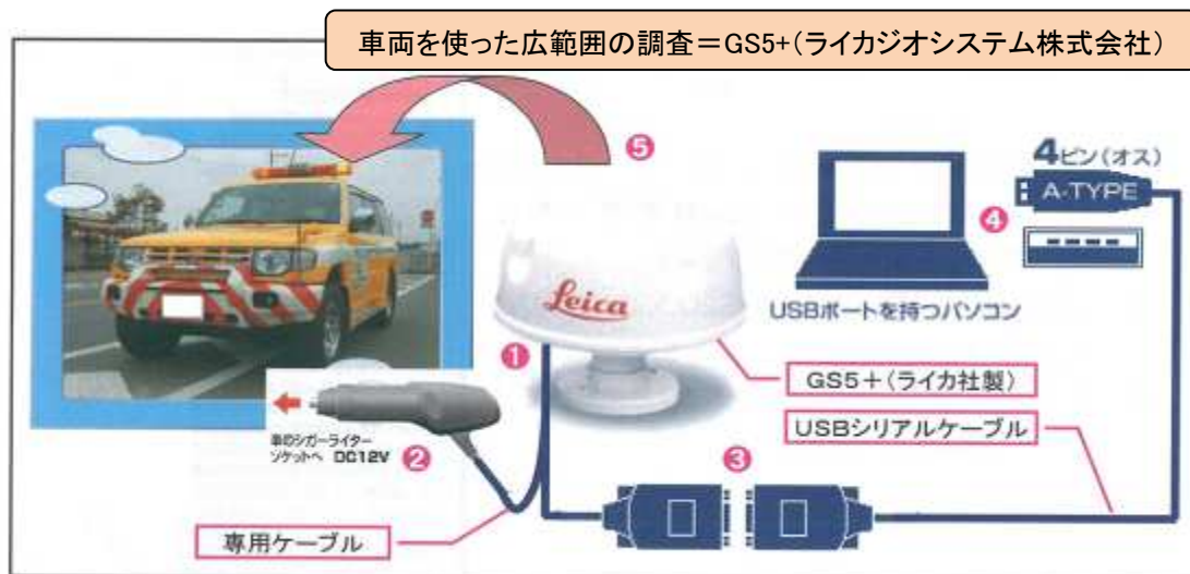
図-2.3 GPS 機器と PC の接続例
