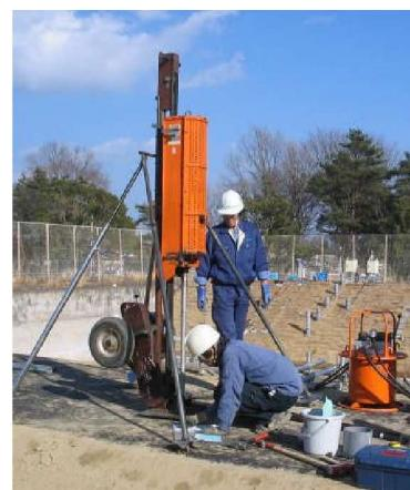
写真-4.3 オートマチックラムサウンディングによる設置状況
