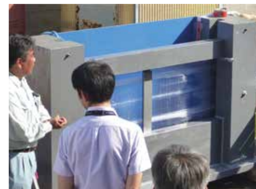
長良川畳堤実物大模型により止水性を確認
