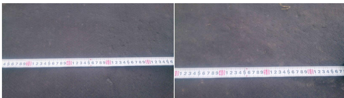
図 1.19 振動ローラ転圧後の保護マット表面(2) 左:碎石(C-40)起振無 右:碎石(C-40)起振有
