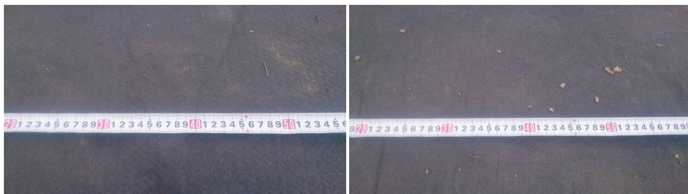
図 1.18 振動ローラ転圧後の保護マット表面(1) 左:まさ土(起振無) 右:まさ土(起振有)
