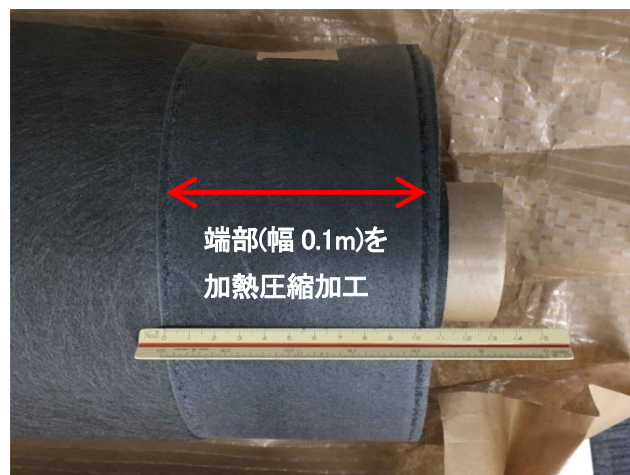
図 1.5 ブリーザブルシート端部加熱圧縮加工
