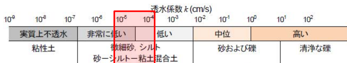
図 2.1 透水係数 k の目安 (赤枠はブリーザブルシート換算相当) 14)
