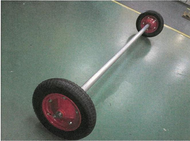
水防シートを巻く棒（竿）の端に車輪を付けた例。
