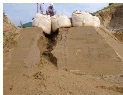
写真-2.3.1 止水性確認試験状況
