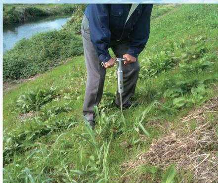
右図は某河川の堤防のり面において、リバーテクノコーンを用いて、堤防表層部の状態について調査を実施した例を示したものです。
