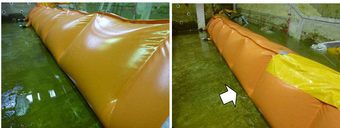
写真 II-16 三角水のう（標準型）の止水状況（左：設置直後、右：水深40cm）
