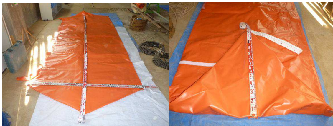
写真 II-1 三角水のう(大型) 寸法計測状況
