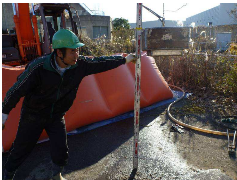
写真 II-23 大型（高強度タイプ）における衝突速度5.0m/s相当時の落下高さ（ \Delta h=91\text{cm} ）
