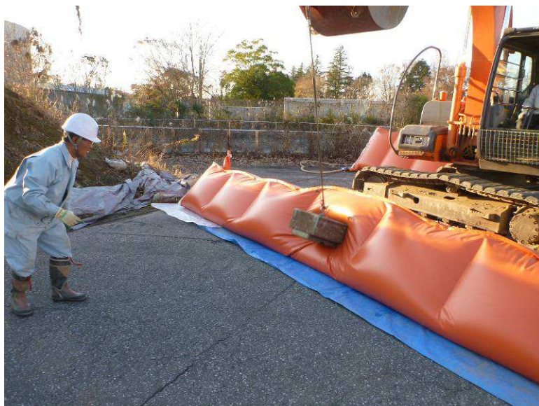
写真 II-21 標準型（高強度タイプ）における衝突速度5.0m/s相当時の衝撃状況
