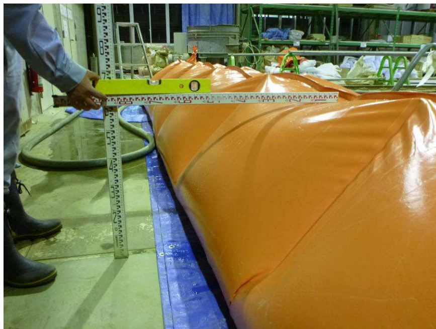
写真 II-9 24時間後の頂点高さ計測状況
