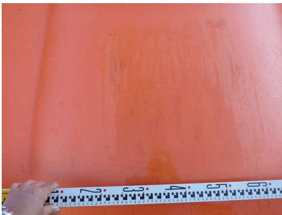
写真 II-25 大型（高強度タイプ）における衝突速度5.0m/s相当時の試験後の表面の状況
