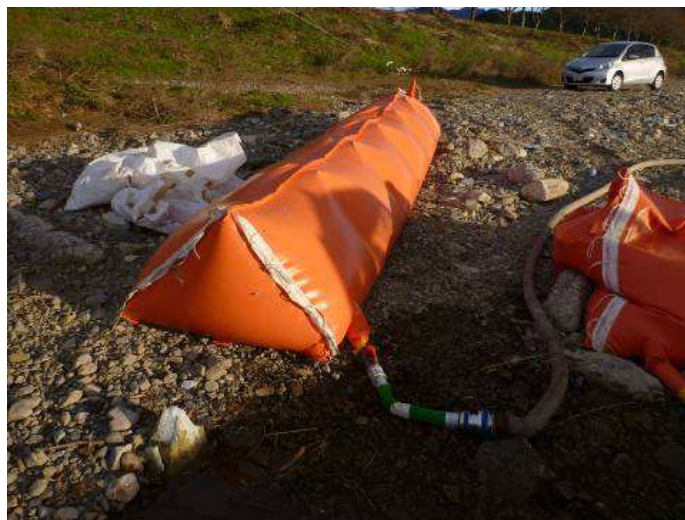
写真 II-30 耐圧性確認試験状況（標準型）
