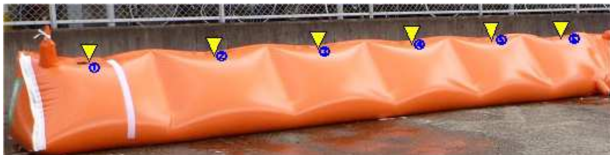
写真 II-8 頂点高さ(最低部高)計測位置
