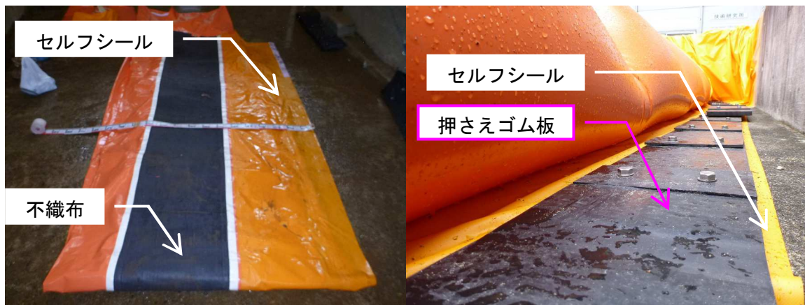
写真 II-5 三角水のう底面の不織布およびセルフシール
