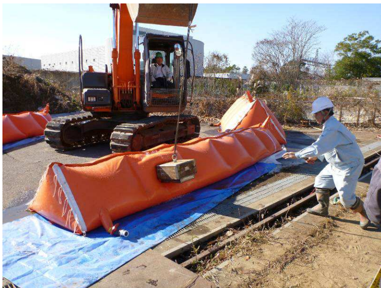
写真 II-22 標準型（標準タイプ）における衝突速度5.0m/s相当時の衝撃状況
