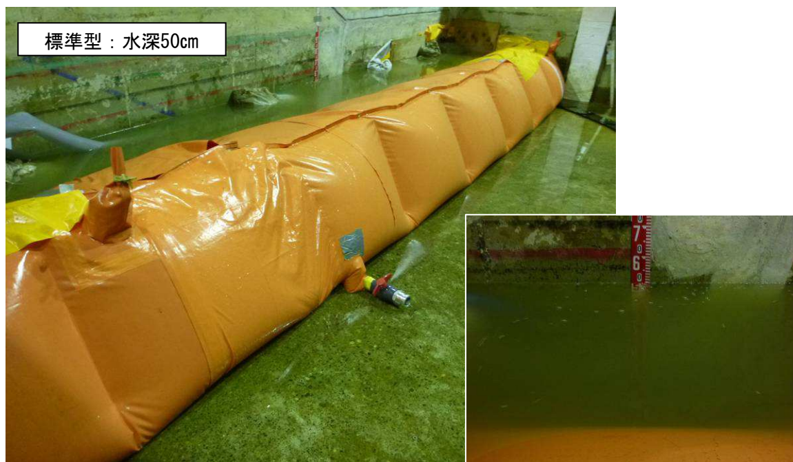
写真 II-13 安定性確認試験の状況（標準型）
