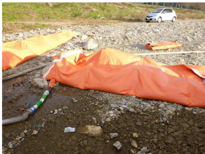
写真 II-31 耐圧性確認試験状況（大型）
