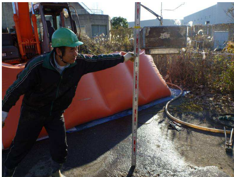
写真 II-23 大型（高強度タイプ）における衝突速度5.0m/s相当時の落下高さ（ \Delta h=91\text{cm} ）
