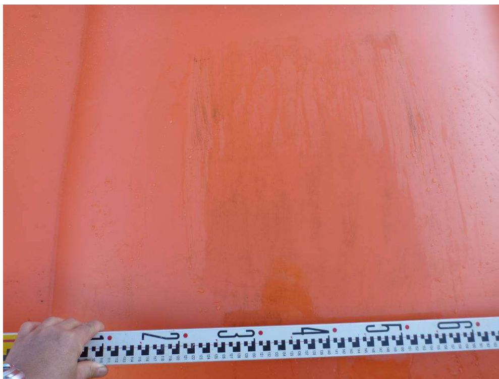
写真 II-25 大型（高強度タイプ）における衝突速度5.0m/s相当時の試験後の表面の状況
