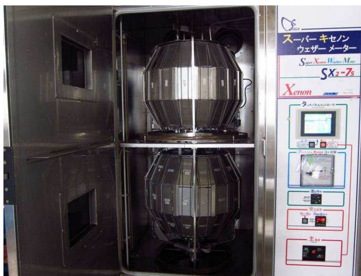
写真 II-33 促進耐候性試験機
