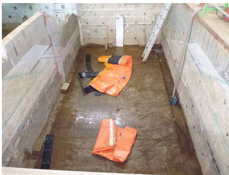
写真 II-10 安定性確認試験実験土槽（L＝8.0m）
