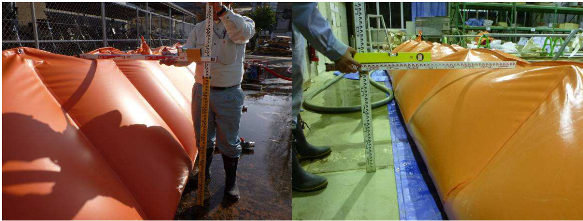
写真 II-3 注水後の『三角水のう』外観および計測状況(左：大型、右：標準型)
