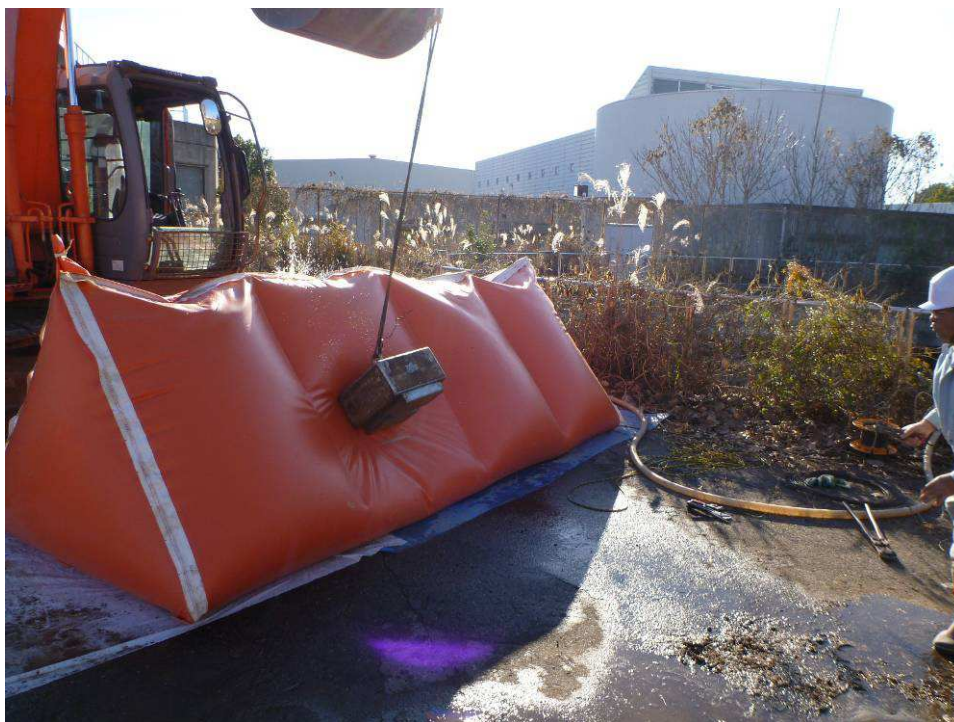
写真 II-24 大型（高強度タイプ）における衝突速度5.0m/s相当時の衝撃状況
