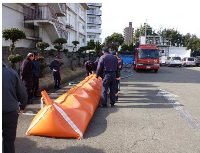
写真 II-32 消防車から吐出圧力0.5MPaにて注水確認（参考）
