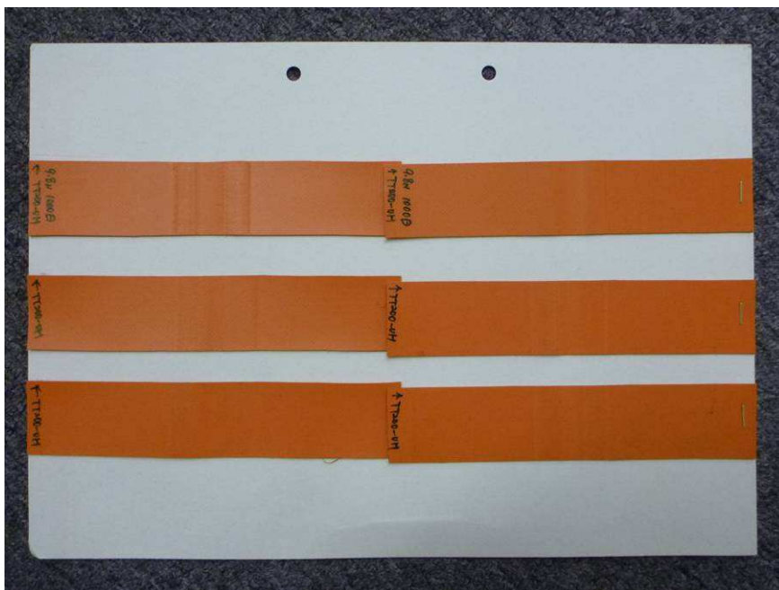
写真 II-27 揉み試験後の試験片（高強度タイプ）
