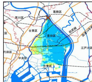
図 3-5 洪水発生時の浸水予測シミュレーション結果
