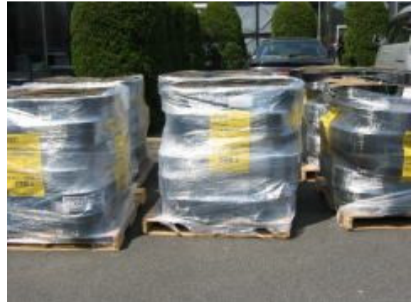
写真-2.2 ジオセルの保管状況
